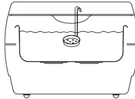
Bandeja de fresas suspendida directamente en el tanque.
