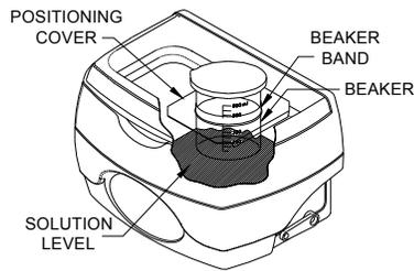
Si utiliza uno o varios vasos de precipitado, colóquelos en una cubierta de posicionamiento utilizando la banda del vaso para ajustarlo a la profundidad de la suspensión de modo que la parte inferior del recipiente se encuentre levemente debajo de la superficie de la solución en el tanque principal, pero sin tocar la base.
