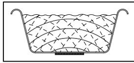
Las ondas sonoras se transportan por la solución en un tanque y crean un patrón de vibración único que produce presiones altas y bajas alternantes en el líquido.
