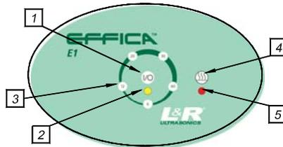
El Temporizador digital controla el funcionamiento y las opciones del Equipo de limpieza por ultrasonidos. Se dispone de tres secciones de control; Encendido principal (Main Power), Temporizador (Timer), Calor (Heat).
